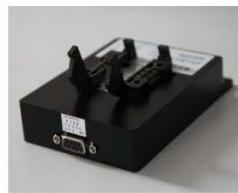
本夹具为针对通信及传感行业常用BF14、BF8、TF系列蝶形激光器开发和设计，适用于常用的N型、S型及BF8小蝶形封装激光器，对客户自定义引脚定义可提供定制服务。采用蝶形夹具可以无需焊接对激光器进行测试、调试和试验使用，避免引脚误连而造成激光器的损伤及失效。适用于广大研究所、大专院校及相关生产企业使用。本公司可提供但不限于以下几种引脚定义：BF14-N型、BF14-S型、BF8小蝶型。
